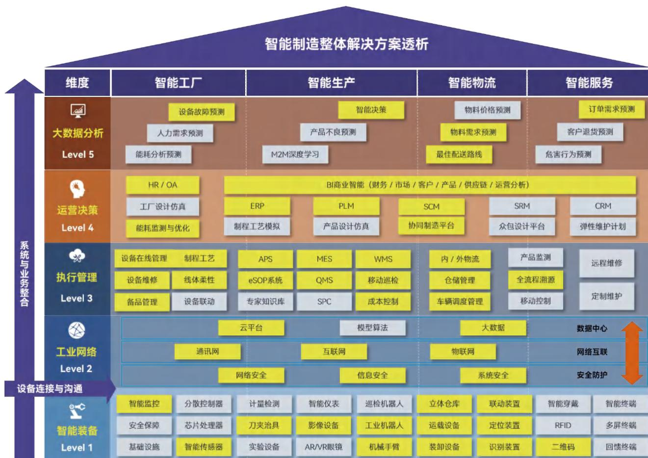
在智能工厂的整体规划过程中，我们以底层工业工程、信息科技、自动化、行业专家作为四大人才支撑；云存储计算、移动终端、物联网、大数据、智能分析、工业互联网、机器人作为关键技术；通过“标准化、自动化、信息化、网格化、智能化”的五大升级步骤，实现安全、品质、速度、弹性、成本、环保六大绩效目标。
